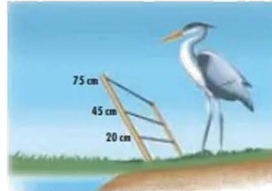
Elektrozäune zum Schutz gegen Fischreiher sind ca. 0,75 m hoch, mit 2 bis 3 Drähten. Bei seichtem Uferverlauf ist der Zaun zur Wasserfläche hin geneigt.
